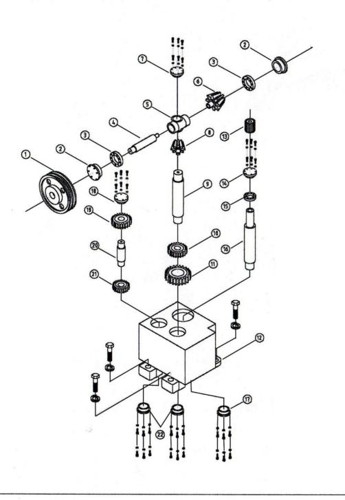
$\begin{array}{c} {\rm TOKU~BAR~BENDER~(TKBB\text{-}32)~GEAR~BOX} \\ {\underline {\rm EXPLODED~DRAWING}} \end{array}$
